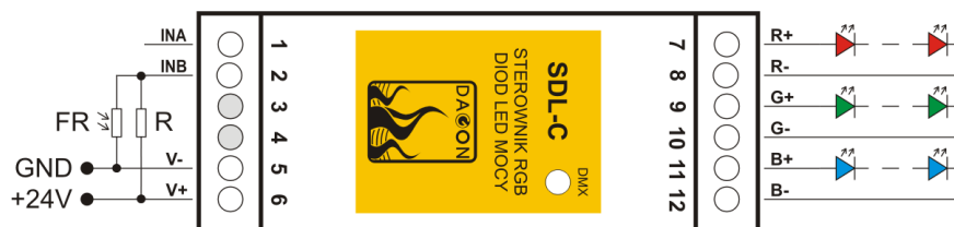
Rys.5. Sposób realizacji czujnika zmierzchowego w SDL-C.
