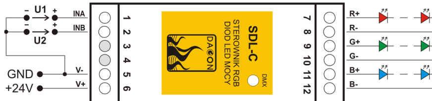
Rys.4. Sposób podłączenia sygnałów analogowych do SDL-C.
