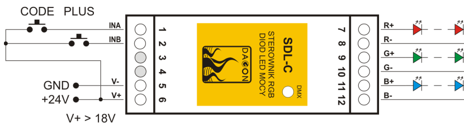
Rys.2. Sposób podłączenia zewnętrznych przycisków konfiguracyjnych.
