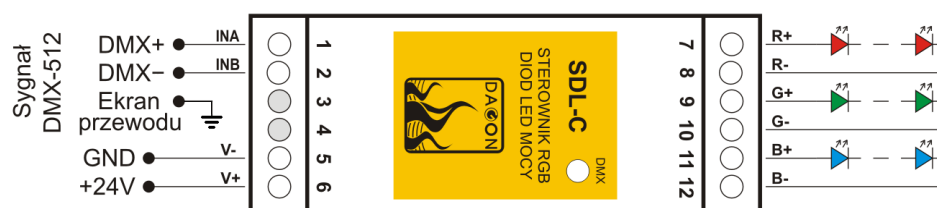
Rys.6. Sposób podłączenia sygnału DMX-512 do SDL-C.
