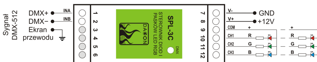
Rys.6. Sposób podłączenia sygnału DMX-512 do SPL-3C.
