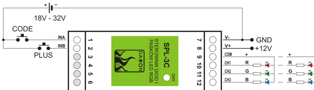
Rys.2. Sposób podłączenia zewnętrznych przycisków konfiguracyjnych.
