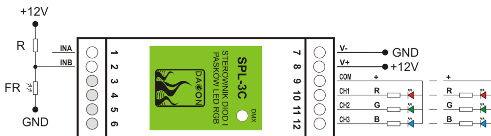
Rys.5. Sposób realizacji czujnika zmierzchowego w SPL-3C.
